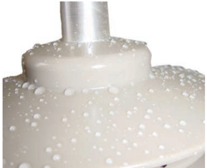
Znaczenie hydrofobowości – kompozycja HCEP nie wykazuje właściwości przewodząco-rezystywnych na skutek kontaktu z wilgocią
