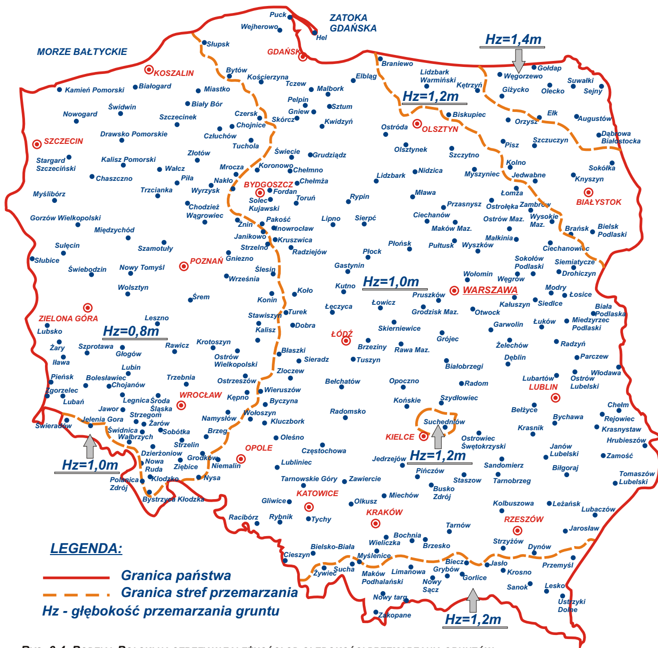
RYS. 6.4. PODZIAŁ POLSKI NA STREFY W ZALEŻNOŚCI OD GŁĘBOKOŚCI PRZEMARZANIA GRUNTÓW.
