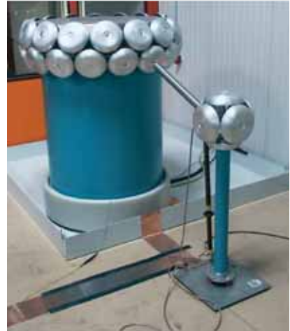
AV test equipment up to 150 kV/75 kVA
