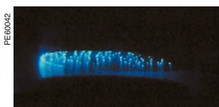
Rys. 3: rozproszony łuk w komorze typu AMF
