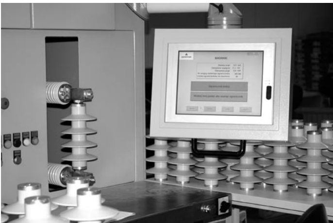
Zdj. 1. Stanowisko prób wyrobu ogranicznika typu ASM
