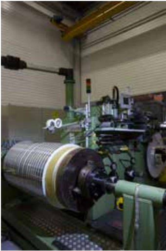
Uzwojenie wysokiego napięcia w technologii paskowej
