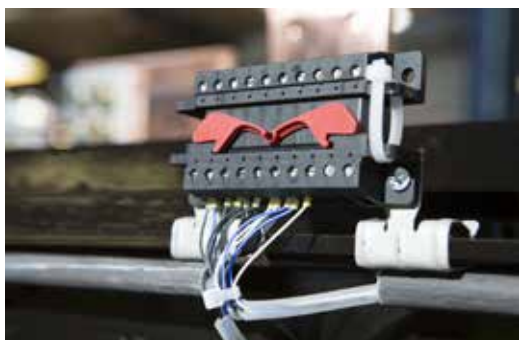
Listwa zaciskowa do podłączenia czujników do przetwornika elektronicznego
