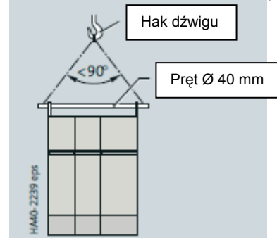
Transport dźwigiem z wykorzystaniem pręta
