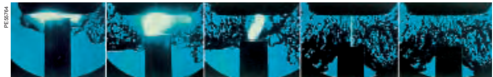
Łuk elektryczny w termoeekspansyjnej komorze wyłączającej
